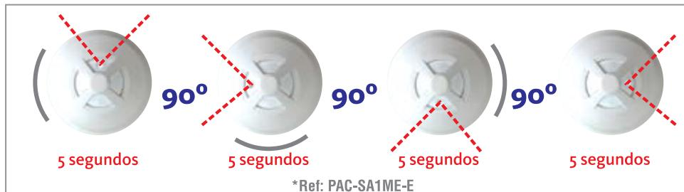
O “i-see Sensor” move-se em rotações de 90°, com intervalos de 5 segundos, até completar uma circunferência, de forma a cobrir todo o espaço.
